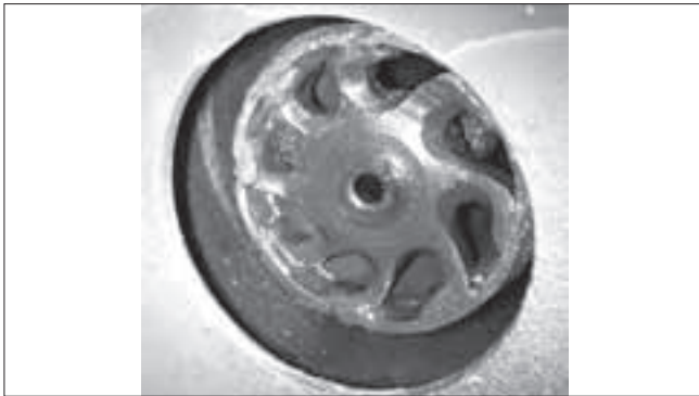
▲ شکل ۲: سرمشعل به کار رفته در مشعل‌های مایع سوز مورد استفاده در کوره‌های دوار ذوب چدن
