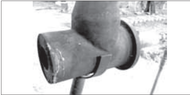
▲ شکل ۱: یک نمونه مشعل گازوییل سوز مورد استفاده در کوره‌های دوار ذوب چدن
