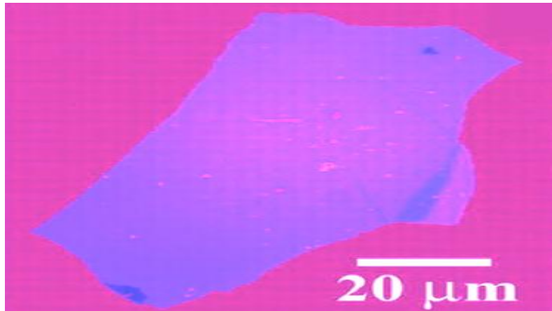
شکل (۱-۴): اولین تصویر میکروسکوپ نوری منتشر شده از گرافن تهیه شده به روش پوسته پوسته کردن میکرومکانیکی. [۶]
